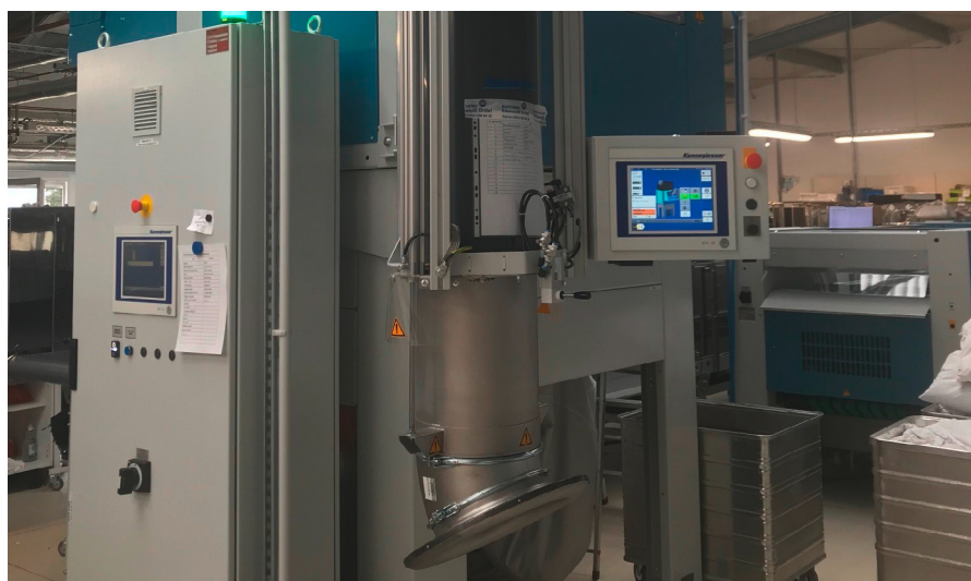
Neuer hocheffizienter und direkt beheizter Gastrockner DC 60
