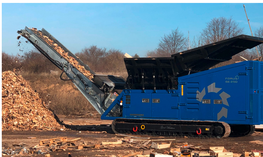
Der neu beschaffte Holzbrecher Forus Typ SE 250 ermöglicht eine Leistungssteigerung um 50 Prozent.
