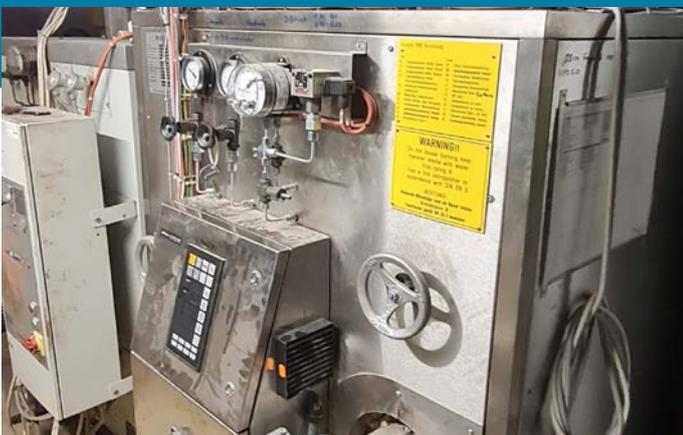
Effizienter Gärvollautomat mit Glykolheizung zur Abwärmenutzung.
