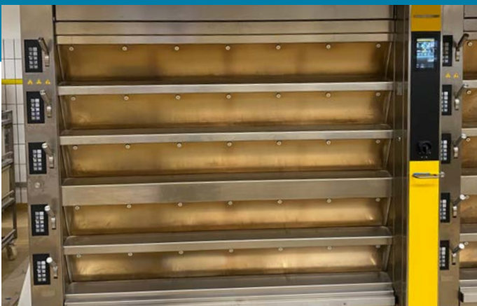
Energieeffizienter Gas-Etagenbackofen mit modulierenden Brennern in der Produktion des Backhauses Siemer.
