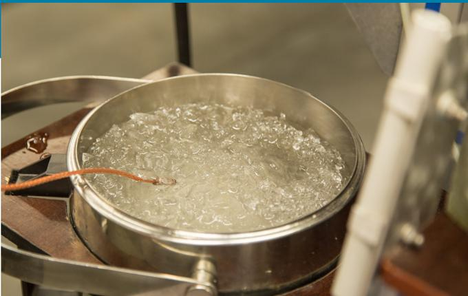
Dewar-Gefäß zur dezentralen Eisbadbereitstellung am Arbeitsplatz mit zentraler Eiszerzeugungsanlage
